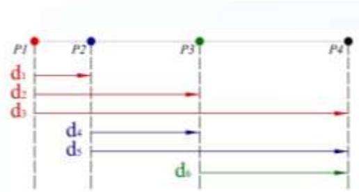
Fig. 1: Distancias a ser medidas en una base Heerbrugg.
