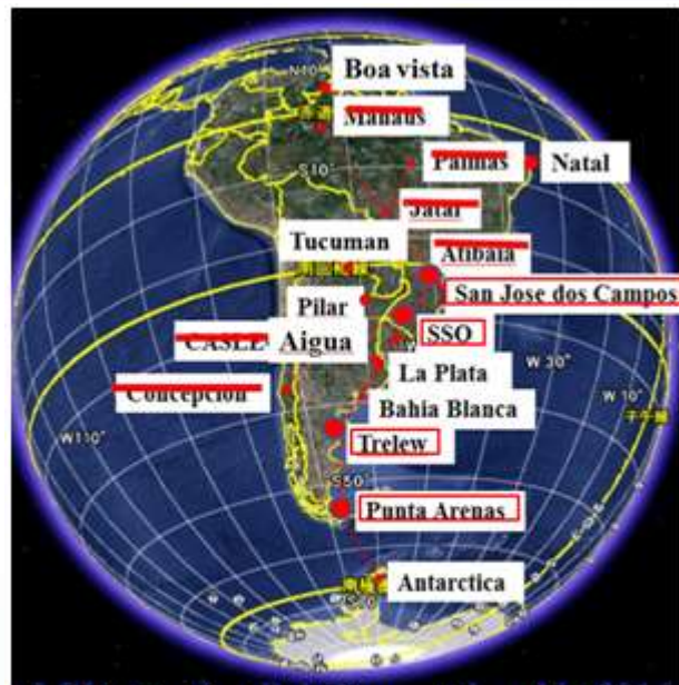
Fig. 2 Distribución de estaciones de la red SARiNet. Las ubicaciones recuadradas son las que presentan riómetros 2D mientras que tachadas son las que actualmente esta fuera de servicio
